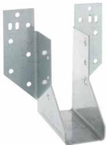
L'étrier SHT est un sabot à bretelles utilisé pour la connexion de fermettes sur support bois. Il est ajustable en hauteur sur chantier car il peut être installé les ailes à plat sur le porteur ou les ailes repliées.
