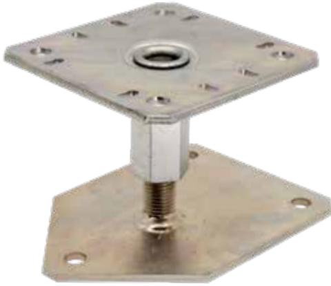
Les pieds de poteau type PBLR ont été conçus afin de répondre aux exigences réglementaires relatives au respect des distances des chevilles mécaniques en bord de dalle béton. Ils peuvent être utilisés indifféremment en angle, au bord ou au centre de la dalle.
