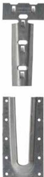
L'étrier à queue d'aronde en acier ETSN est un connecteur innovant et très discret. Il permet de reproduire l'esthétique d'un assemblage traditionnel à queue d'aronde. La partie femelle est placée sur la poutre porteuse avec des vis CSA ou des pointes CNA, tandis que la partie mâle est fixée à l'extrémité de la poutre portée avec les vis à tête plate.
