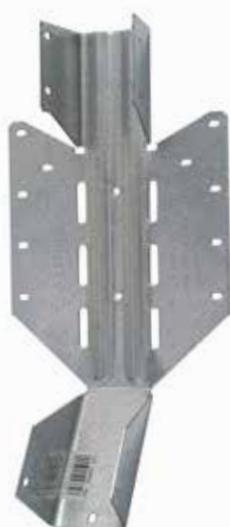
L'étrier à pente et orientation réglables LSSU est un étrier qui permet de régler sur chantier l'angle et la pente nécessaires pour sa mise en oeuvre jusqu'à 45° dans les 4 directions.
