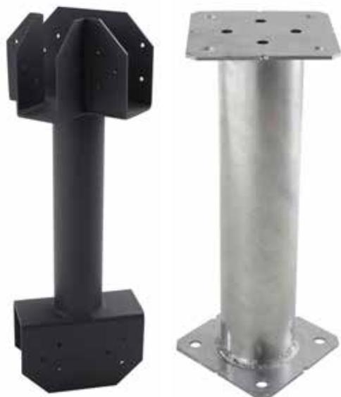
Le poteau métallique configurable OSP peut être utilisé pour supporter des charges axiales, descendantes et ascendantes, en classe de service 3. L'OSP est composé d'un tube circulaire et d'une platine au choix soudée à chaque extrémité.
