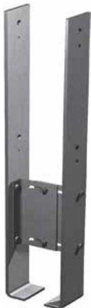
Les pieds de poteaux à sceller CMS et CMR sont constitués de deux pièces en acier galvanisé pour une utilisation en extérieure. Il s'agit de pieds de poteaux réglables en largeur pour des poteaux allant de 80 à 140 mm (CMS) et de 115 à 165 mm (CMR).
