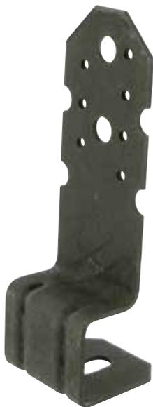
Le pied de poteau PBP60/50 est préconisé pour la réalisation d'ouvrages de type pergola. Il offre une grande polyvalence dans sa mise en œuvre. Il s'utilise par paire pour des sections de poteaux carrés de 70 à 150 mm. Pour des sections plus importantes (250 x 250 maximum), l'utilisation de 4 pieds par poteau est préconisée.
