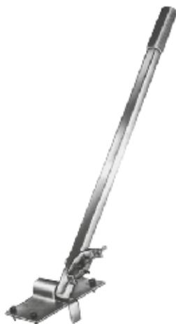
Le tendeur de feuillard BANSTR permet d'assurer la tension du feuillard mis en place afin de limiter le déplacement des fermes sous l'effet du vent. Le BANSTR est adapté aux feuillards de 30 à 60 mm de large.
