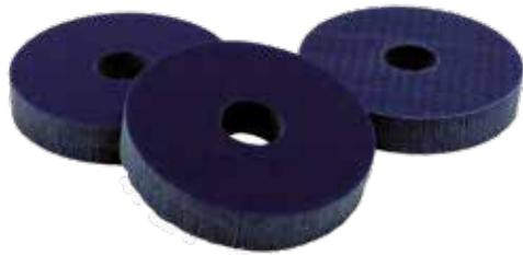
La rondelle SITW s'associe à la bande SIT pour constituer un système performant dans les structures en CLT devant respecter un haut niveau de performance acoustique. Elle s'intercale entre une rondelle métallique et le CLT lors de l'assemblage par vis, évitant la transmission des vibrations par les fixations.
