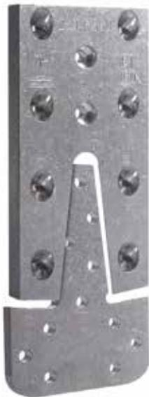
L'étrier à queue d'aronde aluminium ETB est un connecteur très discret. Il permet de reproduire l'esthétique d'un assemblage traditionnel à queue d'aronde sans ses inconvénients. Le prémontage en atelier est conseillé pour une pose rapide sur chantier.
