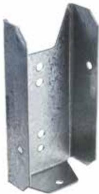
Les étriers de clôture FB24 permettent la fixation de lisses horizontales. Leur revêtement permet une utilisation en extérieur. Ils peuvent être utilisés à l'horizontal ou à la vertical et sont adaptés au bois de 40 mm de largeur.
