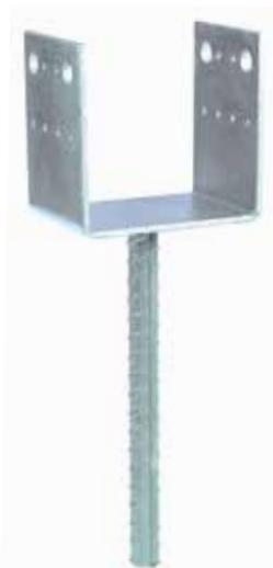
Les pieds de poteau en U à sceller PPD ont été conçus pour faciliter le montage. L'installation dans le béton nécessite des réservations mais permet de régler les niveaux avant de couler le béton.
