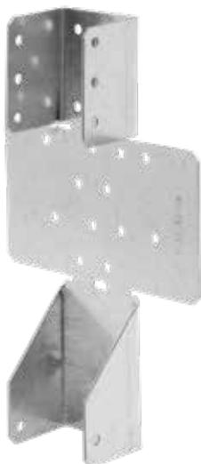
Le SPR permet la fixation de chevrons sur support bois et béton. Le réglage de la pente est fait sur le chantier pour des pentes jusqu'à 45° vers le bas ou le haut. Ce réglage est à effectuer une seule fois dans le sens de la pente souhaitée.
