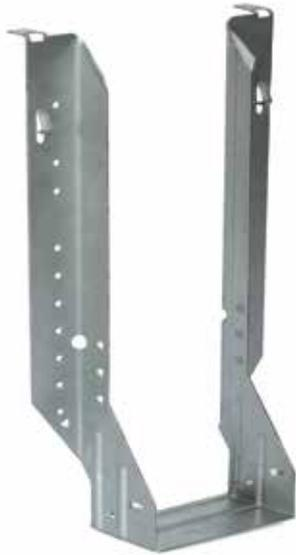
Les étriers IUSE garantissent une mise en œuvre facilitée grâce aux ergots supérieures, tout en assurant un maintien de la membrure basse par strong grip. Le clouage s'effectue sur les brides latérales après un pré-positionnement possible avec le speed prong.
