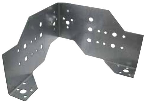
Le connecteur FCC assure la liaison de murs d'ossature sur dalle béton. Les trous de pointes et de boulons permettent d'adapter la fixation en fonction des configurations. Ce connecteur peut éventuellement être associé à un feuillard perforé type FP30 à fixer sur les montants.
