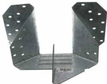
Cet étrier pour croupe est utilisé dans la fermette de section 38 mm. Il permet la réalisation d'une croupe en assemblant les demi-fermes d'arêtier et d'empañon.
