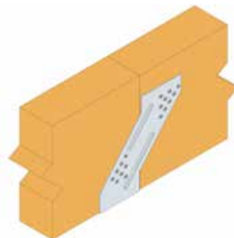
Sabot cantilever SCR installé avec CSA
