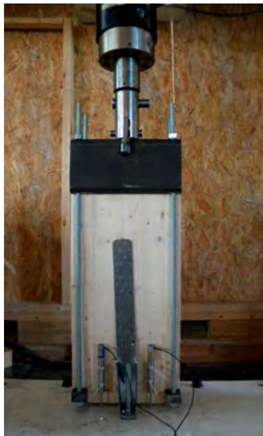
HTT22 soumis à des tests cycliques
