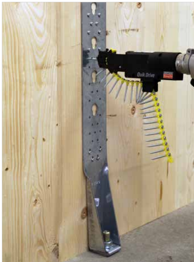
Ancrage HTT31 fixé à l'aide de vis en bande CSA pour une connexion mur CLT sur dalle béton
