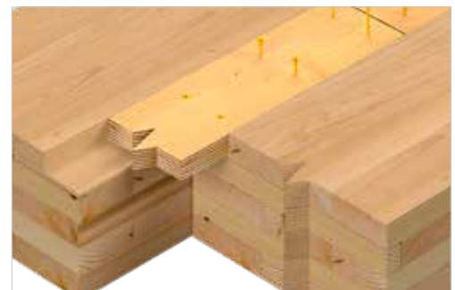
Vis SWC avec languette bois
